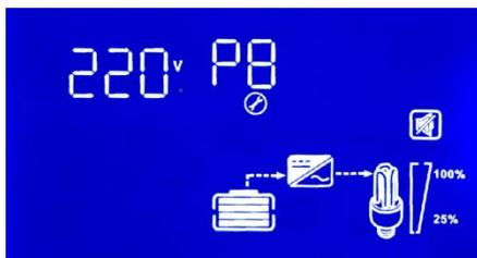
P8: Ajuste de la tensión de salida del inversor: 220V por defecto, (208V, 210V, 220V, 230V, 240V)
