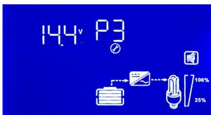
P3: Ajuste de carga uniforme del voltaje de la batería: 12,5V ~ 15,5V (individual) se puede ajustar.
