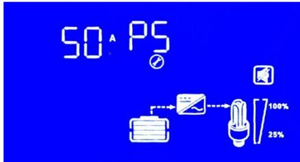
P5: Ajuste de la corriente máxima de carga de red: (Por defecto 300W:10A、500W-1500W:15A、2000W: 20A、3000W-12000W:50A) 5A, 10A, 20A, 30A, 40A, 50A
