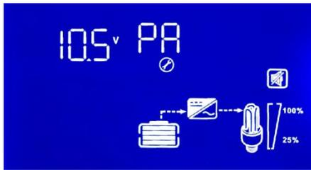
PA: modo de prioridad de la batería bajo voltaje de la batería a la configuración de voltaje de red:
