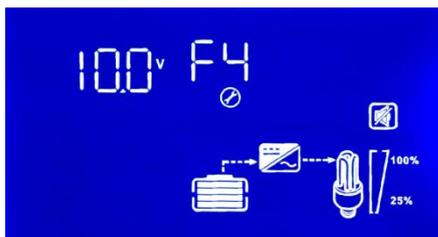
F4: Modo desatendido voltaje de la batería baja potencia apagado punto de ajuste: (debe :  $P_n > P_L > F_4$ )
