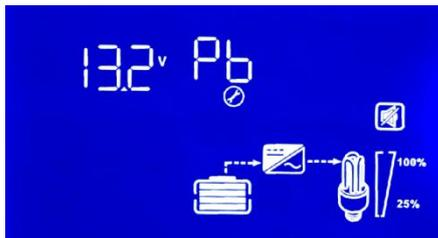
PB: modo de prioridad de la batería, cuando el voltaje de la batería se restaura inversor de voltaje de conversión de energía de la ciudad:
