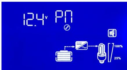
Pn: modo desatendido, batería bajo voltaje restaura el ajuste de voltaje de arranque:(debe :  $P_n > P_L > F_4$ )
