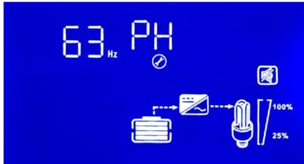
PH: Ajuste de la frecuencia máxima de entrada de AC:
