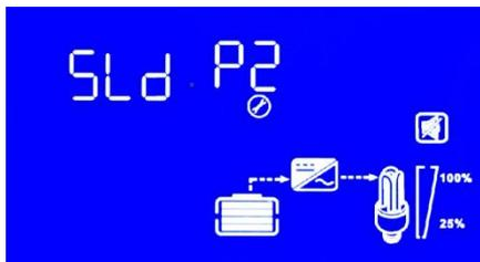
P2: Ajuste del tipo de batería y de la tensión de carga:
