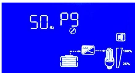
P9: Ajuste de la frecuencia de salida de CA: 50Hz por defecto, (50Hz, 60Hz)
