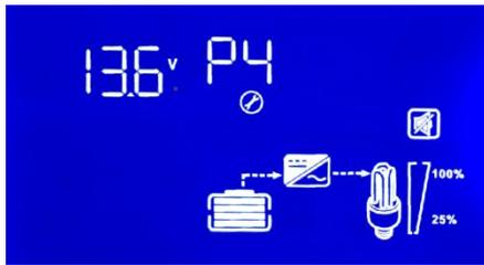
P4: Ajuste de carga flotante del voltaje de la batería: 12,5 ~ 13,9 (simple) se puede ajustar.
