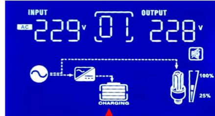
Modo de red (el icono de capacidad de la batería parpadea cuando se está cargando, cuando no se está cargando o se ha completado dejará de parpadear )
